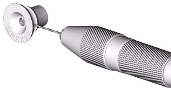
Рис. 1. Прочистка отверстий для компонента А (изоцианат)
